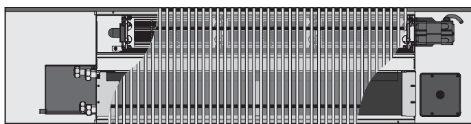
Системный конвектор с принудительной конвекцией QSK HK 320 или QSK HK 360 (4-х трубный)
